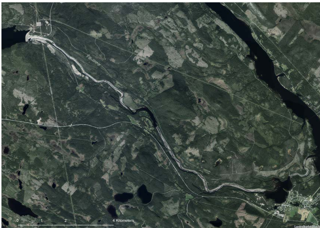
Foto 4. Flygfoto över Letsi torråra. Längst upp till vänster i bild ligger Letsi kraftverk. Det grå i bilden är torråran. De två mörka, vattentäckta partierna i bilden är vattenytor som däms upp med spegeldammar.
