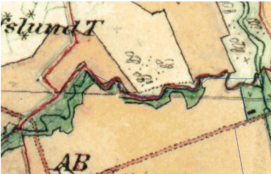
Figur 3. Vattendragssegmentet bedöms vara rätat efter undersökning och jämförelse mellan Häradskartan med vattendragsskiktet i Fastighetskartan.
