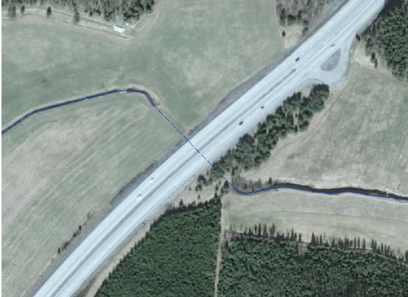
Figur 2. Vattendragssegmentet under vägen bedöms vara kulverterat och vattendragssegmenten runt vägen är grävda efter undersökning med ortofoto och vattendragsskiktet i Fastighetskartan.
