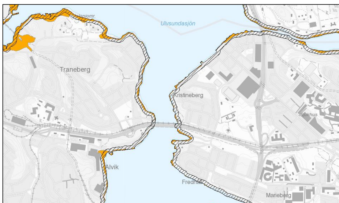
Figur 2. Exempel på hur närområdesanalysen (30 m zon i kartan ovan) resp. svämplansanalysen (orange områden) har genomförts för att klassa status för morfologi och sedan som underlag för att klassa betydande påverkan från "Förändring av morfologiskt tillstånd – annat/urban markanvändning".
